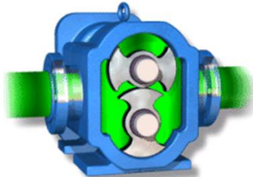
Bomba de engranaje tipo lóbulos
